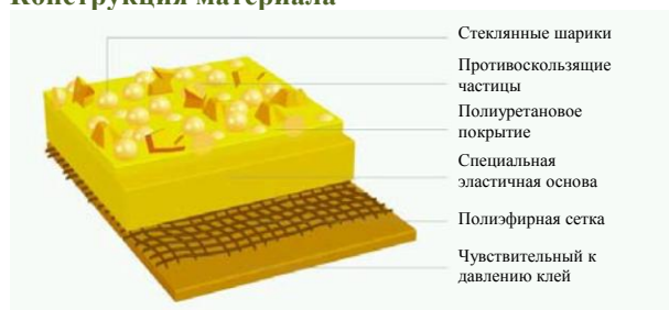
Рисунок 1. Конструкция лент серии А650
